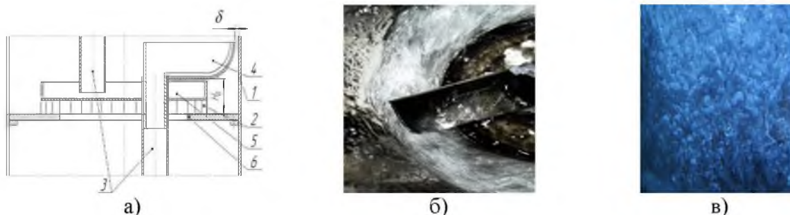
1 – царга; 2 – контактное устройство (завихритель); 3 – переточный патрубок; 4 – сливная планка; 5 – гидрозатворный стакан; 6 – полотно тарелки; 7 – патрубок для подачи жидкости
